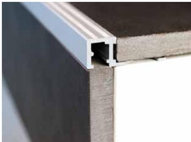
SQUAREJOLLY SJR avec Résine Grip est un profilé à section carrée pour la finition et la protection des bords des carreaux de nez de marches. Design minimal et moderne, idéal pour les applications domestiques. Les sections de résine en surface confèrent au profilé la propriété antidérapante, certifiée R11. Ils ont une bonne résistance à l'abrasion (PEI 3) et aux attaques chimiques.
